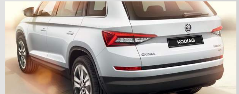
פס כוורת אחורי - מוטיב עיצובי ופונקציונאלי שמטרתו להגן על הפגוש בעת הטענת
