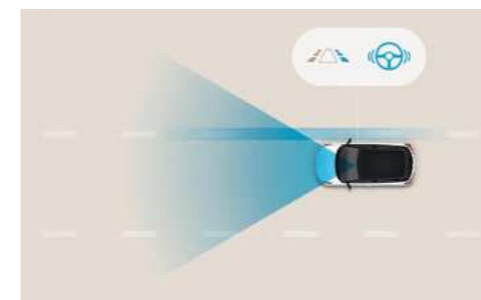
מערכת סיוע לשמירה על נתיב הנסיעה (LKA) מערכת אקטיבית הכוללת תיקון הגה לסיוע בשמירה על נתיב הנסיעה.
