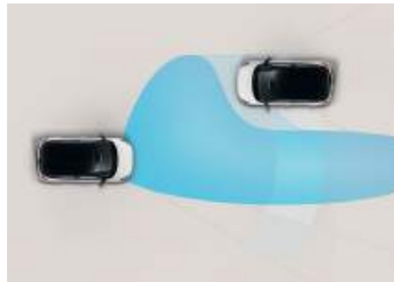
מערכת למעבר אוטומטי בין אור גבוה לנמוך (HBA) החלפה אוטומטית בין תאורת דרך לאור גבוה בהתאם לתנאי הדרך, מונעת סינוור רכבים ומגבירה את הבטיחות בנהיגת לילה.
