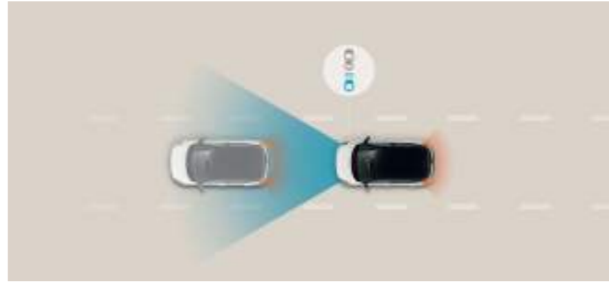
בלימה אוטונומית במצבי חירום (FCA) שילוב של מצלמה ורדאר המתריעים מפני סכנת התנגשות, ועצירה אקטיבית של הרכב במצב חירום.
