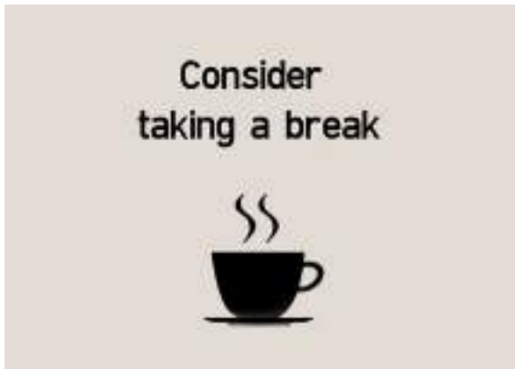
מערכת התראה על עייפות הנהג/ת (DAW) מערכת המזהה סימני עייפות אצל הנהג/ת, מתריאה על כך וממליצה על הפסקת התרעננות.
