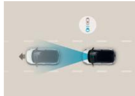
התראה על תחילת נסיעה של רכב מלפנים (LVDA) בזמן עמידת הרכב ובמידה ויש רכב מלפנים המערכת תתריע על התחלת הנסיעה של הרכב מלפנים
