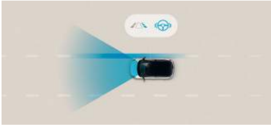
בקרת סטייה מנתיב + תיקון הגה (LKAS) סיוע אקטיבי בשמירה על נתיב הנסיעה, הכולל חייווי בלוח השעונים, התראה קולית ותיקון אקטיבי של נתיב הנסיעה.
