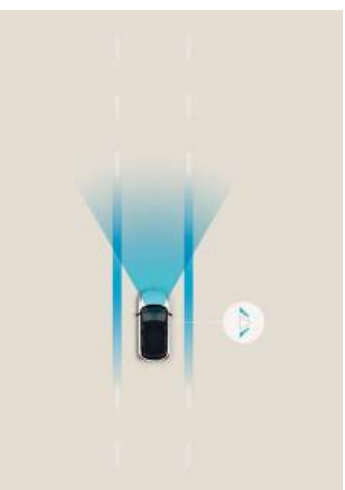
מערכת סיוע לשמירה על מרכז נתיב הנסיעה (CTA) מערכת אקטיבית המסייעת במשמירה על מרכז נתיב הנסיעה.
