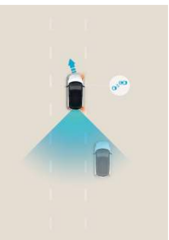
מערכת לזיהוי ומניעת התנגשות בגלי רכב ב"שטח מת" (BSM) מערכת אקטיבית למניעת התנגשות במטב מעבר ענפי המספיקות החלפה על רכב ב"שטח מת.
