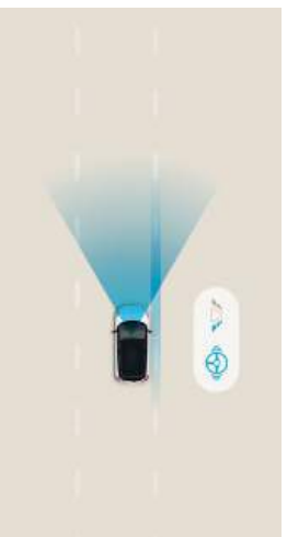
מערכת אקטיבית הנלולת תיקון הגה (LKA) מערכת אקטיבית הנלולת תיקון הגה לסייע במשמירה על נתיב הנסיעה.
