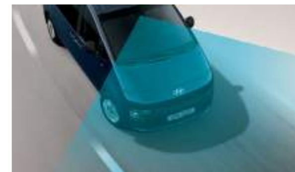
מערכת סיוע לשמירה על מרכז נתיב הנסיעה (LFA) מערכת אקטיבית המסייעת בשמירה על מרכז נתיב הנסיעה.
