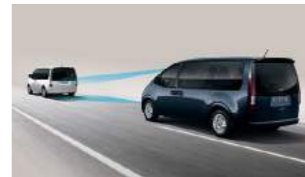
בקרת שיוט חכמה (SCC) שומרת על מהירות ומרחק קבועים מהרכב שמלפנים בעזרת חיישן רדאר ושולטת בהאצה והאטת הרכב באופן אוטונומי עד עצירה מוחלטת.
