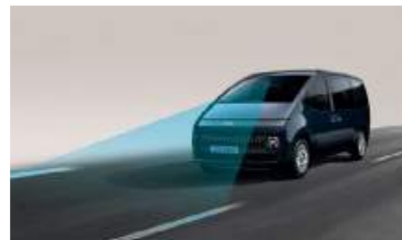
מערכת אקטיבית הכוללת תיקון הגה לשמירה על נתיב הנסיעה (LKA) מערכת אקטיבית הכוללת תיקון הגה לסיוע בשמירה על נתיב הנסיעה.
