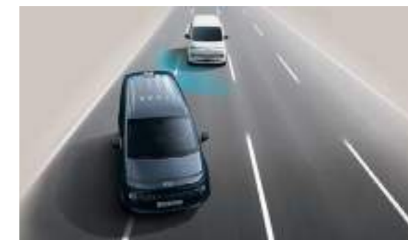
מערכת אקטיבית לזיהוי ומניעת התנגשות בכלי רכב ב"שטח מת" (BCA) מערכת אקטיבית למניעת התנגשות בעת מעבר נתיב המספקת התרעה על רכב ב"שטח מת".
