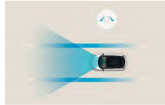
מערכת אקטיבית לשמירה על מרכז נתיב הנסיעה (LFA) מערכת מבוססת מצלמה ורדאר המזהה סטייה ממרכז הנתיב ומציעה תיקון הגה אוטומטי.
