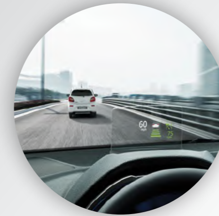
מסך תצוגה עילי Head-up display* מציג נתונים בנוחות מקסימלית תוך כדי נהיגה ללא צורך בהורדת המבט מהכביש.
