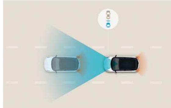
בלימה אוטונומית בעת חירום (FCA-JT) מערכת אקטיבית המתריעה מפני סכנת התנגשות ועצירה של הרכב במצב חירום. המערכת כוללת זיהוי כלי רכב, דו גלגלי ותנועה פונה בצומת.
