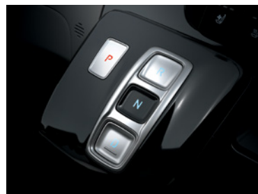
SBW (Shift By Wire) בחירת הילוך נסיעה בכפתור*
