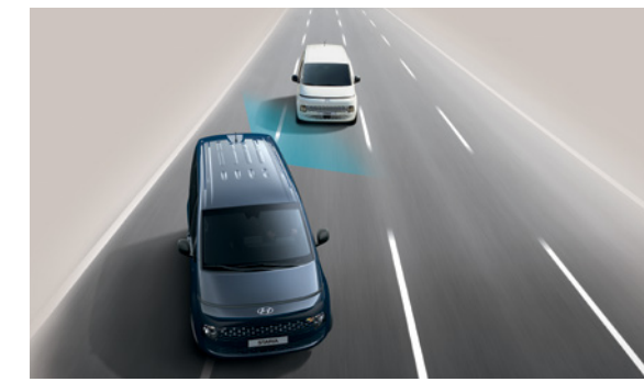
מערכת אקטיבית לזיהוי ומניעת התנגשות בכלי רכב ב"שטח מת" (BCA) מערכת אקטיבית למניעת התנגשות בעת מעבר נתיב המספקת התרעה על רכב ב"שטח מת".
