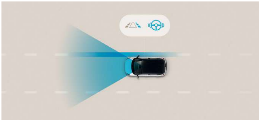
בקרת סטייה מנתיב + תיקון הגה (LKA) סיוע אקטיבי בשמירה על נתיב הנסיעה, הכולל חייווי בלוח השעונים, התראה קולית ותיקון אקטיבי של נתיב הנסיעה.
