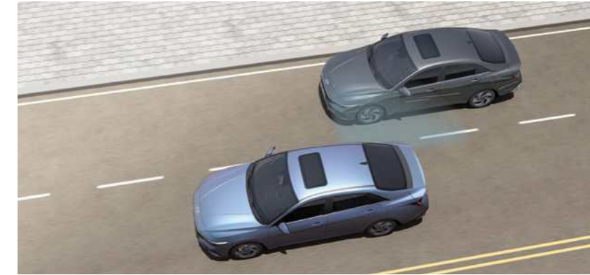
מערכת אקטיבית לזיהוי ומניעת התנגשות בכלי רכב ב"שטח מת" (BCA)* מערכת מבוססת רדאר המתריעה על רכבים ב"שטח מת" בעת מעבר נתיב ומבצעת תיקון הגה אוטומטי במידה והנתיב אינו פנוי.
