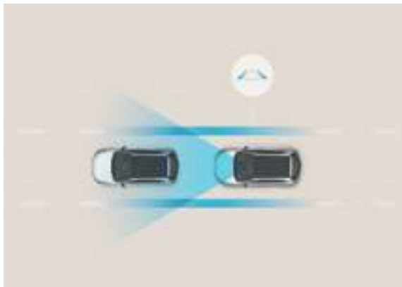
מערכת אקטיבית לשמירה על מרכז נתיב הנסיעה (LFA) מערכת מבוססת מצלמה ורדאר המזהה סטייה ממרכז הנתיב ומציעה תיקון הגה אוטומטי.
