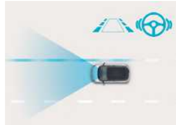
מערכת אקטיבית הכוללת תיקון הגה (LKA) מערכת אקטיבית הכוללת תיקון הגה לסיוע בשמירה על נתיב הנסיעה. כאשר המערכת מזהה סטייה מנתיב הנסיעה, היא מבצעת תיקון הגה אוטומטי בכדי למנוע את הסטייה מהנתיב.
