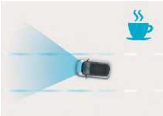
מערכת התרעה על ערנות נהג (DAW) התרעה קולית ומטר כתוב המציע הפסקת ריענון להגברת הבטיחות במצבים של עייפות או חוסר ריכוז.
