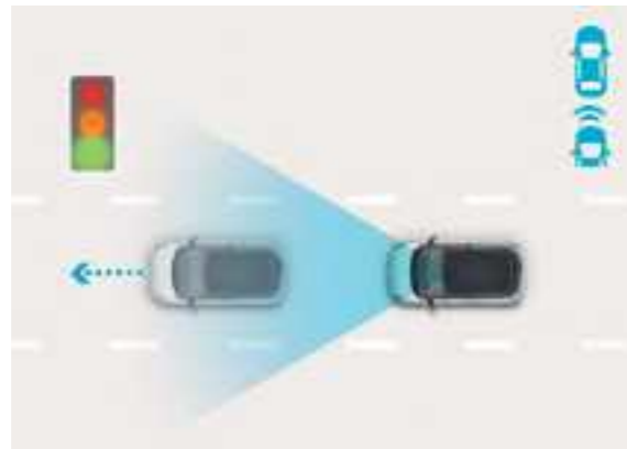
התרעה על התחלת הנסיעה של הרכב מלפנים (LVDA) בזמן עצירה ובמידה ויש רכב מלפנים המערכת תתריע על התחלת הנסיעה של הרכב מלפנים.
