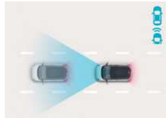
בלימה אוטונומית במצבי חירום (FCA) מערכת אקטיבית המתריעה מפני סכנת התנגשות. במידה וסכנת ההתנגשות עולה לאחר ההתרעה, המערכת תבצע בלימת חירום אוטומטית. המערכת כוללת זיהוי כלי רכב ודו גלגלי.
