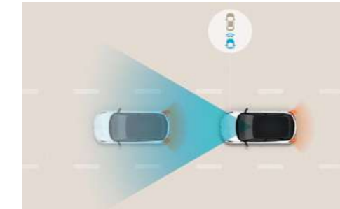
בלימה אוטונומית במצבי חירום (FCA) מערכת להתרעה מפני סכנת התנגשות, ובלימה אקטיבית של הרכב במצב חירום.
