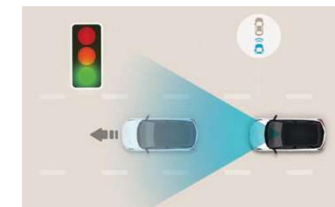
התרעה על התחלת הנסיעה של הרכב מלפנים (LDVA) בזמן עצירה, המערכת תתריע על התחלת נסיעה של הרכב מלפנים.
