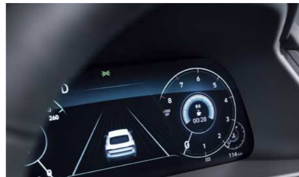
מערכת התרעה על ערנות נהג (DAW) התרעה קולית ומסר כתוב המציע הפסקת ריענון להגברת הבטיחות במצבים של עייפות או חוסר ריכוז.
