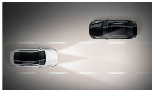
מערכת למעבר אוטומטי בין אור גבוה לנמוך (HBA) החלפה אוטומטית בין תאורת דרך לאור גבוה בהתאם לתנאי הדרך, המונעת סינוור רכבים ומגבירה את הבטיחות בנהיגת לילה.
