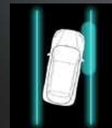
מערכת שמירה על נתיב הנסיעה הכוללת תיקון סטייה אקטיבי
