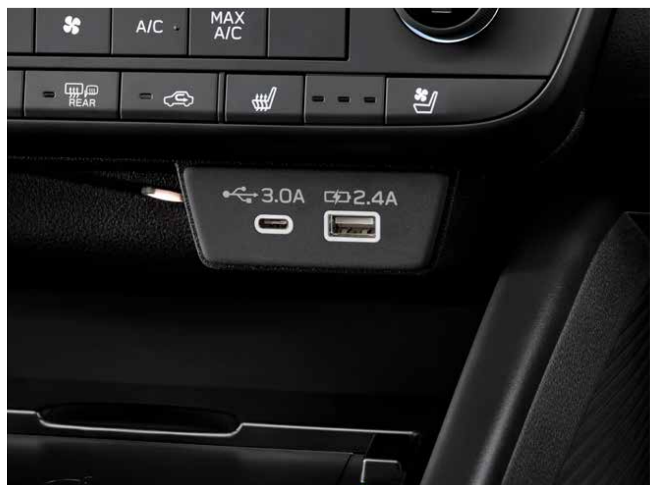
יציאות USB קדמיות (C-I Type-A) ושקעי כוח USB מאחור
