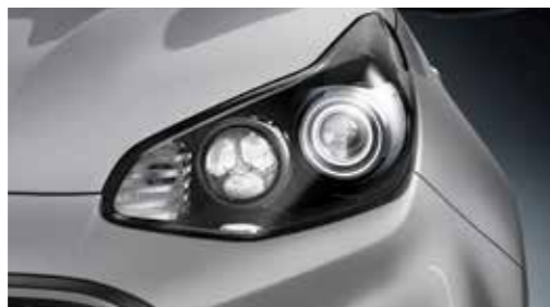
יחידות תאורה קדמיות משולבות תאורת יום מסוג LED
