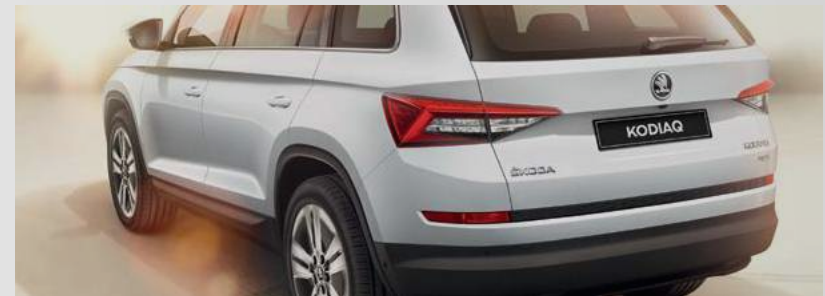
פס סורת אחורי - מוטיב עיצובי ופונקציונאלי שמטרתו להגן על הפגוש בעת הטענת ציוד
